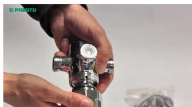
Placer le mécanisme dans son logement.
