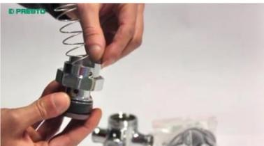
Replacer le ressort et la bague de serrage.
